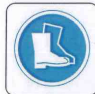
SO-190 USO OBLIGATORIO DE CALZADO DE SEGURIDAD
