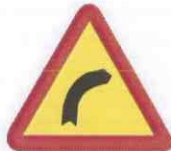
TP-13 a CURVA PELIGROSA HACIA LA DERECHA
