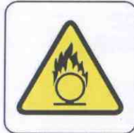
SA-020 ¡PELIGRO! MATERIAL COMBURENTE
