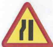
TP-17 b ESTRECHAMIENTO DE CALZADA POR LA IZQUIERDA
