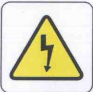
SA-060 RIESGO ELÉCTRICO
